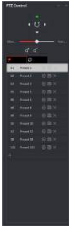
図 6-5 [PTZ 制御] パネル
