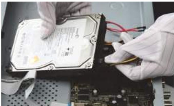
図 2-8 電源ケーブルの接続
