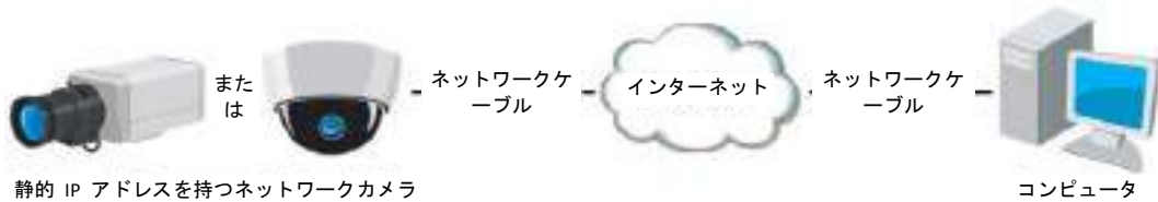
図 2-10 静的 IP を持つカメラによる直接アクセス
