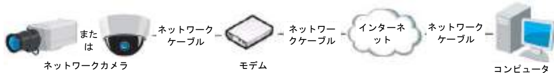
図 2-11 動的 IP を持つカメラによるアクセス
