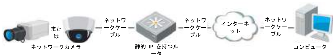
図 2-9 静的 IP を持つルータを経由したカメラへのアクセス
